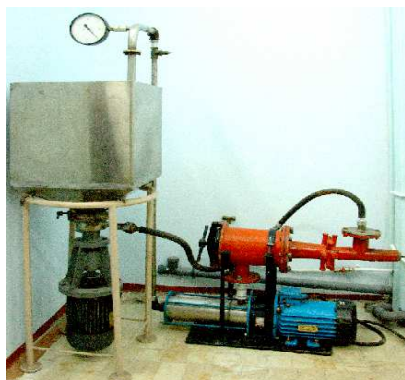
Анализ графиков диспергирования бентонита под действием бичастотной кавитации (рис. 7) показывает, что преобладают частицы размерами (0,3 - 2 мкм). Рис. 6. Технологическая линия для тонкого диспергирования бентонита.
